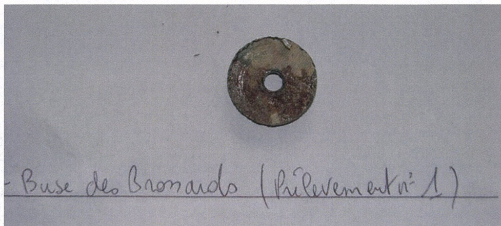
Photo n°17 : Pastillage n°1 - Face externe (côté remblai) - Faiblement corrodée.
