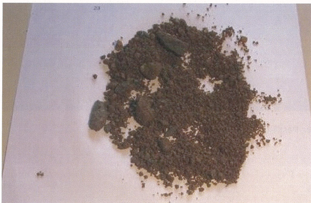
Photo n°16 : Prélèvement de remblai - Sable et petits graviers de schiste.
